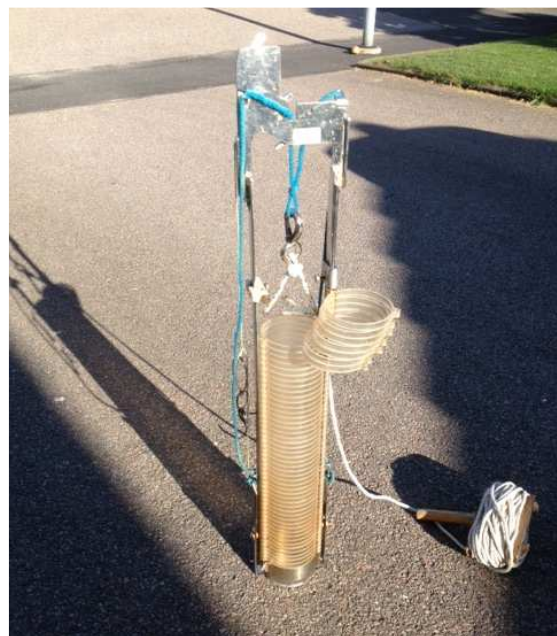
Foto 4. Sedimenthämtare som användes för att skiva sedimenten i önskade centimeternivåer, 0-30 cm (Foto: ALcontrol AB).
